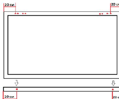
7. После того, как установили И-образный и П-образный кронштейны необходимо с помощью второго человека взять доску с двух сторон и установить на стену.
